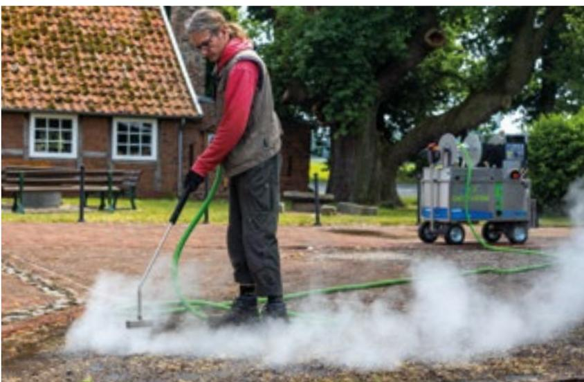
Der ÖKOTHERM ist bei fast jeder Witterung einsetzbar. Er ist speziell für den kommunalen Bereich in Fußgängerzonen, auf Friedhöfen, Bahnsteigen und für überall dort konzipiert, wo auch bei Publikumsverkehr Unkräuter bekämpft werden müssen. Durch seine kompakte Bauweise ist der ÖKOTHERM besonders für alle Bereiche geeignet, die durch entsprechende Großgeräte nicht erreichbar sind.
