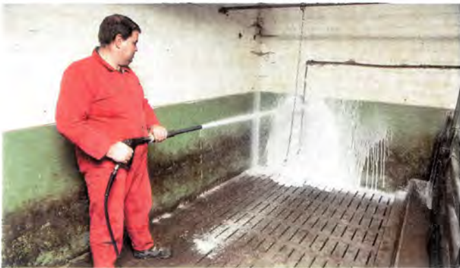
Beim Einsatz des Injektors zum Einweichen fällt der Schaum sehr wässrig aus, das Reinigungsergebnis ist deswegen aber nicht zwangsläufig schlechter.
