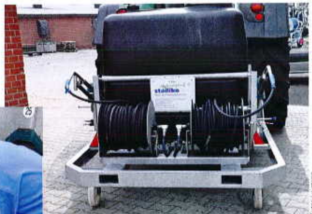
Der zapfwellengetriebene Hochdruckreiniger von stadiko ist nach Kundenwunsch entstanden.
