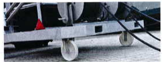
Der Reiniger kann entweder gerollt oder per Stapler aufgenommen und bewegt werden.
